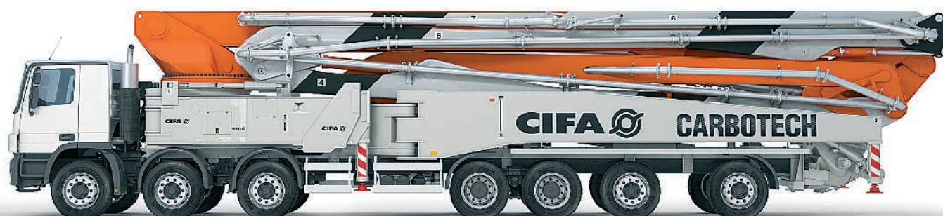
Nowa pompa do betonu Cifa K80H z 80 m długością ramienia wysięgnika wzbudza sensację swoim wyglądem
